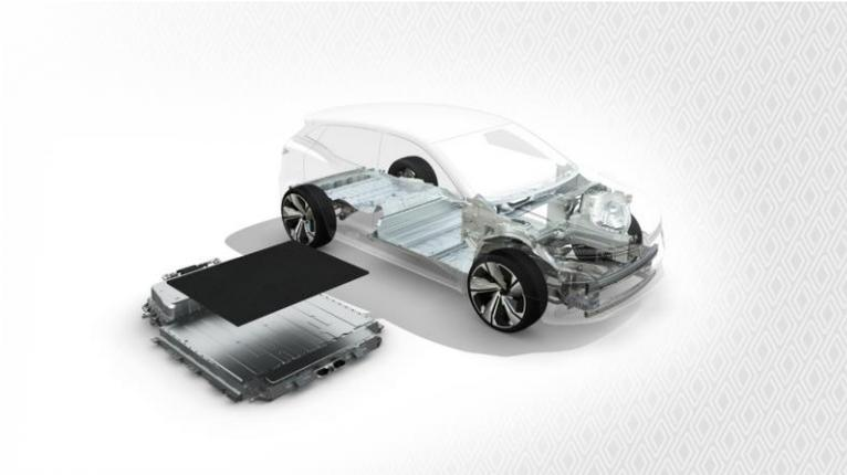
Die Innovation führte auch zu einer dünneren Bodenplatte, was wiederum mehr Platz für die Passagiere bietet und das Gewicht reduziert. Daraus resultiert eine optimierte Energieeffizienz, was wiederum die Reichweite des Elektrofahrzeugs erhöht.
