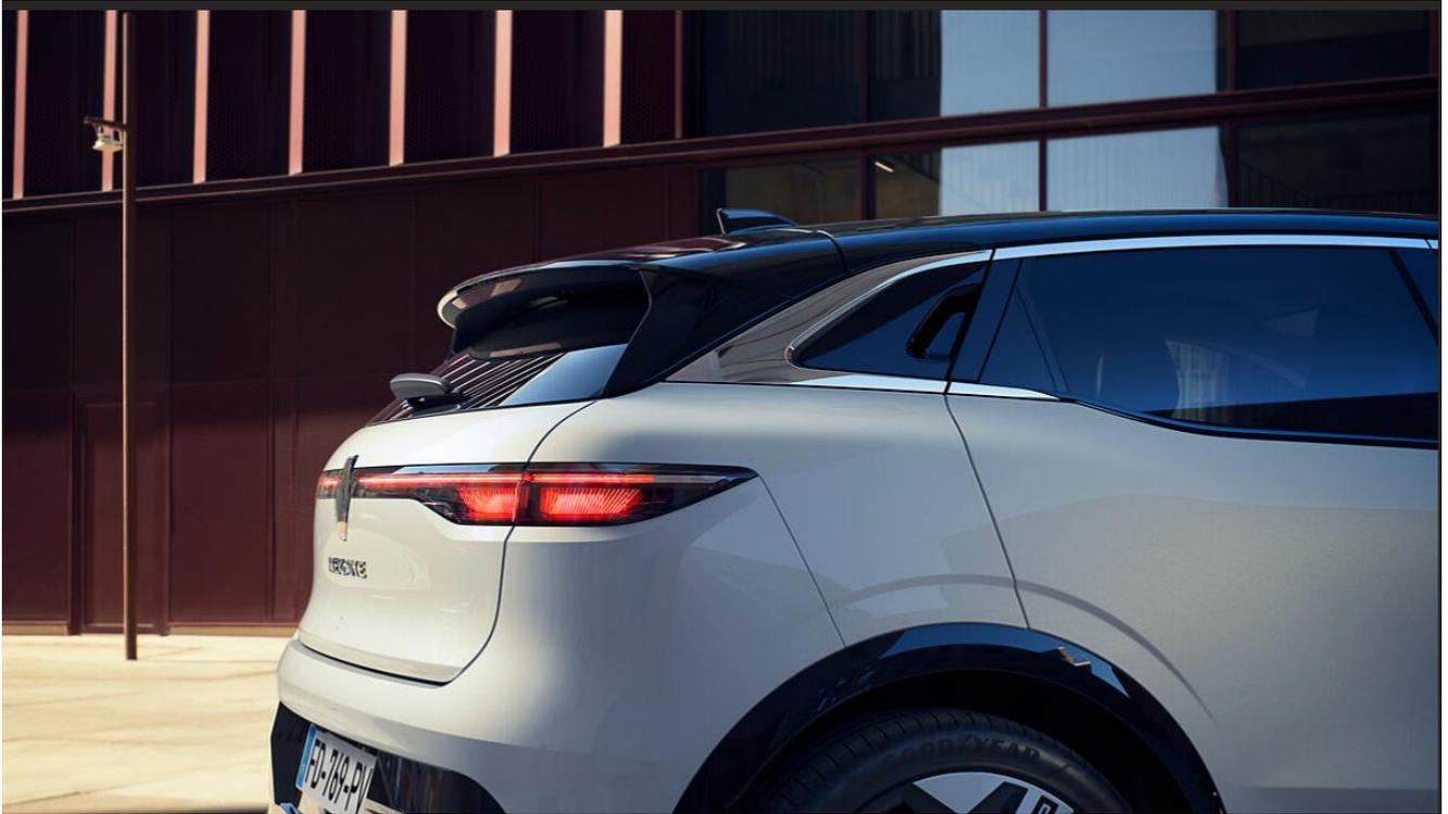
Kunststoff-Heckklappen, wie es sie bei den Fahrzeugen von Renault schon seit mehreren Jahren gibt, ermöglichen eine Gewichtsreduzierung des Fahrzeugs. Außerdem tragen sie zur höheren Wertigkeit des Innenraums bei und bieten den Designern mehr Freiheiten bei der Integration von durchgehenden Heckleuchten.
