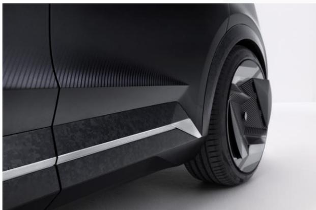
Die unteren Türkanten, die Spurverbreiterungen und die vorderen und hinteren Unterfahrschutzbleche weisen eine matte Oberfläche auf, die aus recycelten Kohlefasern hergestellt wurde. Die Kombination dieser Details ergibt ein dynamisches Konzeptfahrzeug mit einem starken Charakter.
